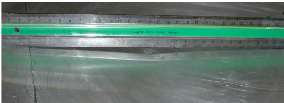
Figur 23: En 8 mm aluminiumsplate etter slaget (213 J). Skaden er 6 mm dyp og har en radius på 15 cm. Skaden er permanent.
